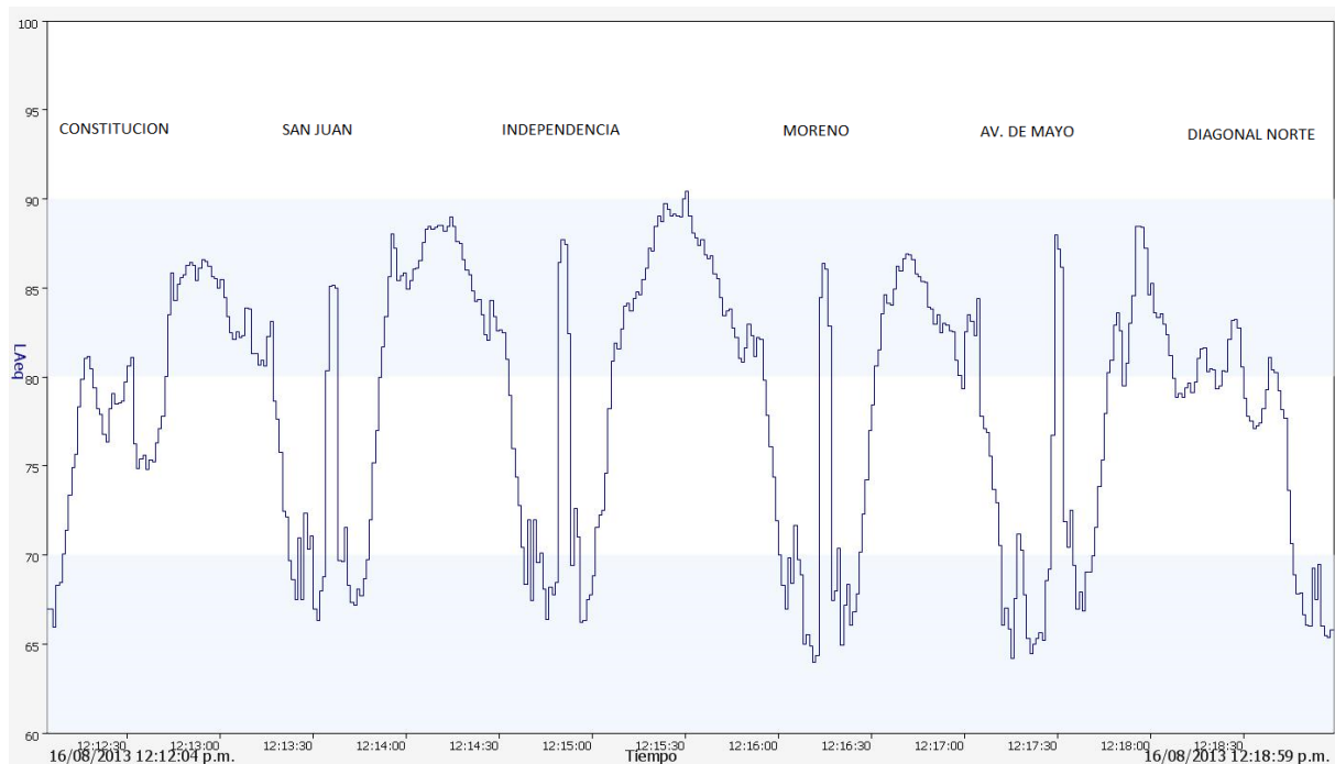
Fig. 3 Leq (dBA) entre las estaciones Constitución y Diagonal Norte (línea C)
